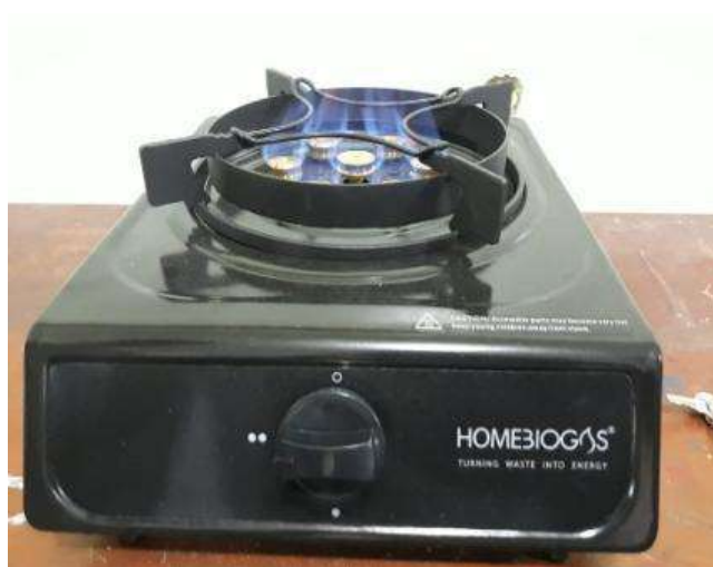
Figura 3. Teste de chama realizado para a continuação do abastecimento com resíduos orgânicos.
